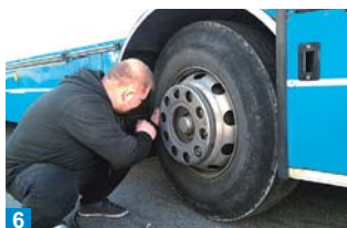
6 Všechny matice se dotáhnou. Po krátké jízdě je třeba zkontrolovat dotažení kola.
