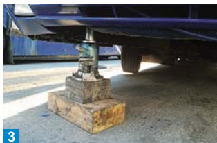
3 Je-li vůz zajištěn proti pohybu a matice jsou uvolněny, může se zdvihnout na heveru.
