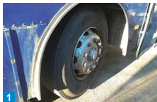
1 Nejprve je nutné zajistit vozidlo proti pohybu, připravit si rezervu, nářadí a pomůcky.
