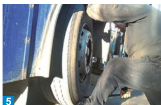
5 Rezervní kolo se nasadí na náboj, namontují se matice a vozidlo se spustí na zem.
